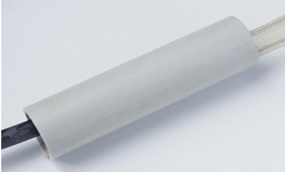
Pour empêcher tout couplage haute fréquence (HF), il faut ensuite réaliser une « self », quelques centimètres après le CI. Pour cela, il suffit simplement d'enrouler le câble coaxial sur 3 ou 4 spires autour d'un manchon de 3 à 4 cm de diamètre. Les spires de cette self seront ensuite immobilisées avec de la colle ou du ruban adhésif et/ou un serre-câble en plastique avant de retirer le manchon (voir Figure 9).
