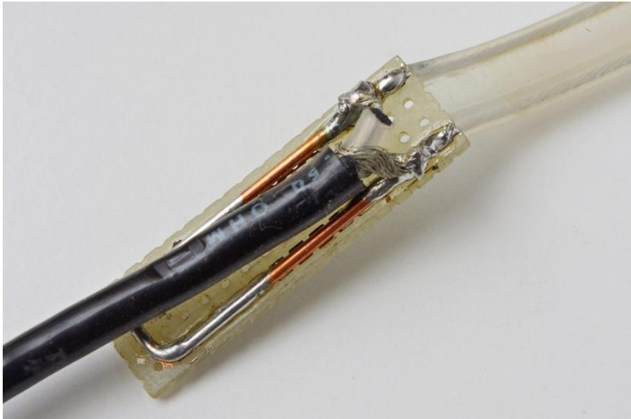
**Figure 5 :** Circuit imprimé vu du côté de l'insertion du Twin-lead (verso)
