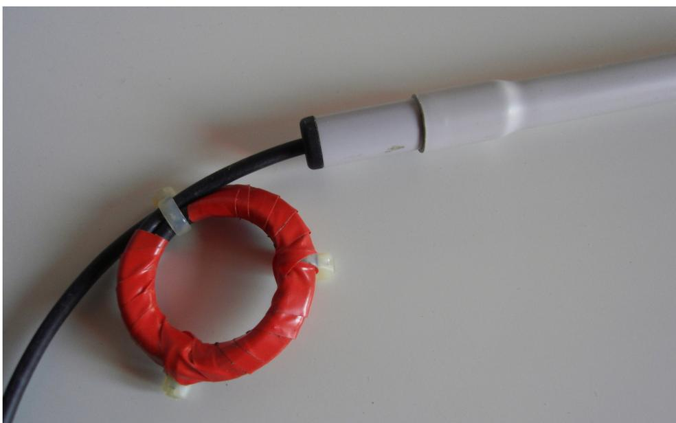
**Figure 12** : Vue du bout de l'antenne sortant du tube PVC (diamètre 16 mm)
