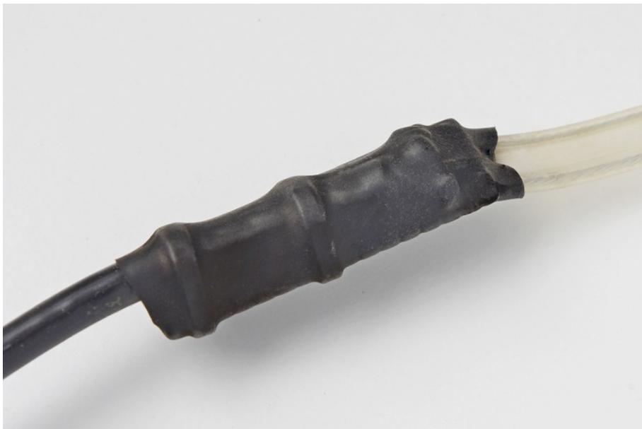
Même si cela n'est pas obligatoire pour le bon fonctionnement de l'antenne, il est conseillé de placer un petit morceau de tube PVC (d'environ 6 cm de longueur) au niveau de la liaison Twin-lead/CI/coaxial en fermant ensuite chaque extrémité avec de la colle à chaud, de l'Araldite ou de la résine (Figure 8). Cela permettra une meilleure protection de l'ensemble à la poussière et aux intempéries.
