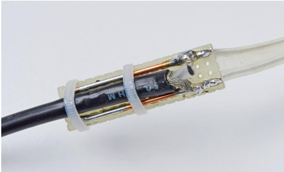
**Figure 7** : L'ensemble Twin-lead/CI/coaxial protégé par un morceau de gaine thermo-rétractable
